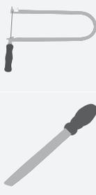
Découpe maintenant toutes les pièces avec une scie à chantourner ou une scie à denture fine. En sciant le long du bord, veille à bien maintenir la lame de la scie à chantourner bien verticalement. Ponce ensuite les arêtes avec une lime ou du papier abrasif. En ce qui concerne la plaque de base (O) il est important de bien arrondir les arêtes supérieures ou les biseauter avec la lime.
