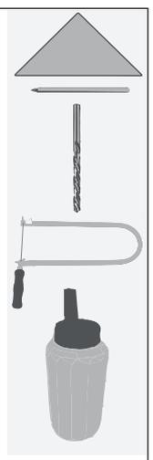
Choisis entre la forme arquée ou la forme en biais et reproduis le gabarit à l'aide d'une règle sur les **pièces latérales (A) (220 / 60 / 10 mm)**. Ensuite, perce les **trous Ø 8 mm**. Découpe les formes avec la scie à chantourner. Travaille tous les bords avec le papier abrasif et **colle ensemble les pièces (A) et (B) selon le schéma.**
